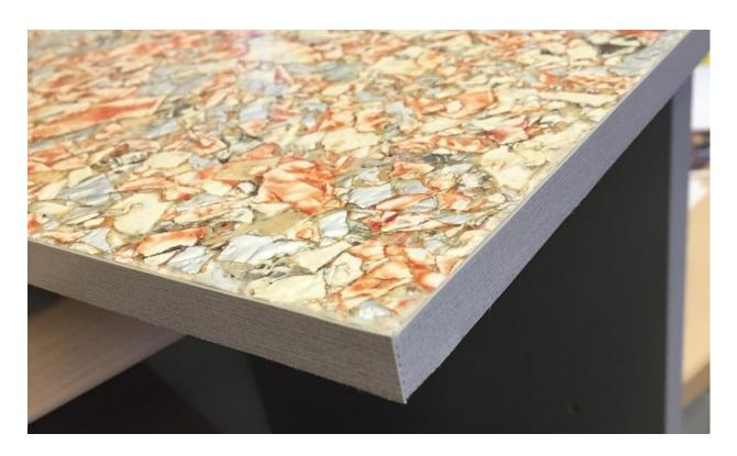
PROYECTO DE RECICLAJE APOYADO POR SIG PARA CONVERTIR LOS ENVASES DE CARTÓN POST-CONSUMO EN MATERIAL DE CONSTRUCCIÓN DE ALTO RENDIMIENTO
